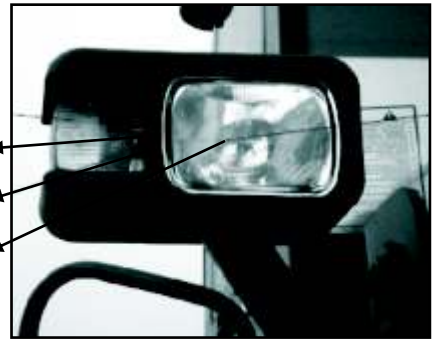
Intermitente 24V/21W Luces de posición 24V/10W Luces delanteras 70W/75W
