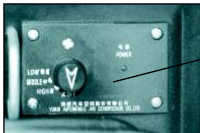
Panel de control de calefacción
