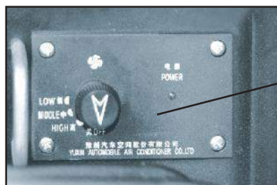
Panel de control de calefacción
