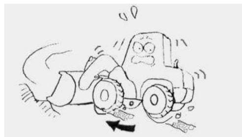
Evite operar en el borde de un acantilado, material suspendido o pozo profundo, si el suelo se derrumba, la máquina se estrellará o volcará, lo que puede causar víctimas graves. Especialmente después de llover, realizar operaciones de voladura o después de un terremoto, el suelo es muy blando y descuidado y propenso a causar peligro.
