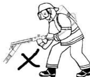
Si las chispas de soldadura vuelan directamente sobre mangueras de goma, cables o tuberías con presión, estos tubos pueden romperse repentinamente y la piel aislante del cable puede dañarse, por lo que es necesario cubrir estos elementos con una trampilla cortafuegos.
