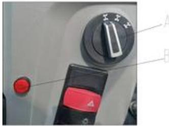
Gire el interruptor a la izquierda para activar el modo de dirección en las 4 ruedas y gire el volante hasta que cambie a modo de cuatro ruedas. Gire el interruptor a la posición central para activar el modo de dos ruedas y gire el volante hasta que cambie a modo de dos ruedas. Gire el interruptor a la derecha para activar el modo de marcha de cangrejo y gire el volante hasta que cambie a modo de marcha de cangrejo.
