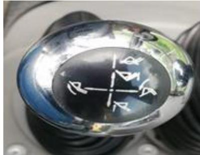
Para aumentar el tiempo del ciclo de operación, al mover y operar varios dispositivos, la palanca de la válvula debe estar completamente presionada hasta la posición requerida. Haga funcionar el motor a velocidad cero y alta, mientras mueve la pluma y el cucharón.
