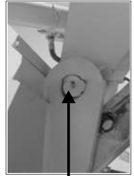
Articulación de los brazos de elevación
