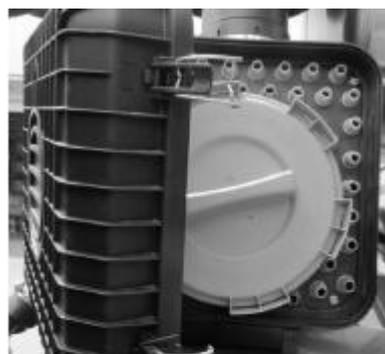
2. Desenrosque la tapa del filtro en la dirección de la flecha.
