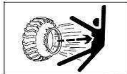
Se necesitan equipos y personal para evitar una inflación excesiva. Las fugas o daños en las llantas se deben al uso incorrecto o inadecuado del equipo inflable. Al inflar el neumático, debe pararse a un lado y utilizar una abrazadera de
