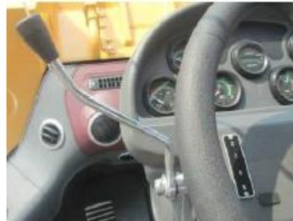
**NOTA:** al realizar la operación de cambio de marchas, primero suelte el pedal del acelerador y luego opere la palanca de cambios para realizar el cambio, a fin de proteger el embrague de cambio de marchas.
