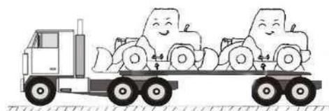
Compruebe si su capacidad de carga puede soportar el peso de la máquina al pasar por un puente o una estructura.
