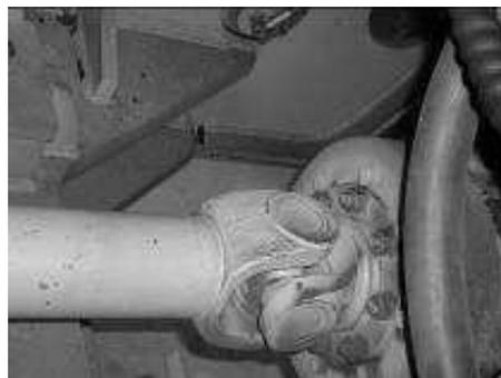
Si se sospecha que la caja de cambios falla, simplemente desmonte los ejes de transmisión delantero/trasero y luego remolque la cargadora.
