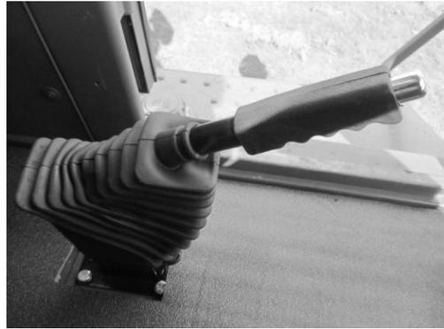
**ADVERTENCIA:** si la cargadora se mueve, pise inmediatamente el pedal del freno de servicio, gire el botón del freno de mano para restablecerlo y aplique el frenado. A continuación, inspeccione si hay alguna falla en el sistema de control de cambio de marchas. Si la cargadora está en una pendiente, asegúrese de bloquear todas las ruedas con calzos para evitar que la cargadora se mueva y luego opere la cargadora.
