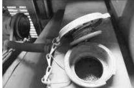
1. Destape lentamente la tapa de presión en la sección superior del radiador de calor y libere gradualmente la presión.
