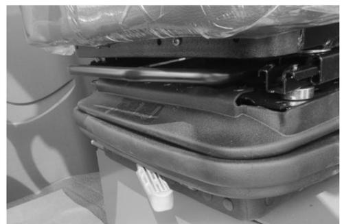
o en el sentido contrario a las agujas del reloj. Hay un peso indicado o cerca del mango. Al girar la manija de ajuste de peso, el indicador de peso indicará un valor diferente, es decir, el peso más adecuado del operador en relación con la rigidez actual del asiento. La flexibilidad del asiento se puede ajustar de forma continua desde 50 kg hasta 130 kg, y la rigidez establecida por el fabricante de la pala es de 70 kg.
