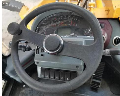
La cargadora está equipada con un mecanismo de dirección motorizado de amplificación de flujo coaxial totalmente hidráulico de tipo articulado, y el ángulo de giro del volante no es igual al ángulo de giro de la cargadora. Cuando el volante se gira continuamente, el ángulo de giro de la cargadora aumentará hasta obtener el ángulo deseado. La velocidad de giro de la cargadora aumentará a medida que aumente la velocidad de giro del volante.
