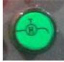
**Indicador de precaución:** Esta lámpara se enciende cuando el operador emite una señal de precaución.
