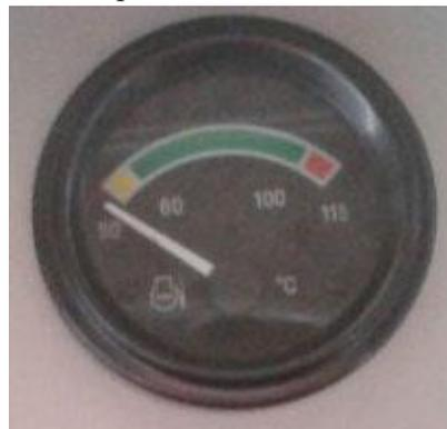
**Medidor de aceite:** Este medidor indica la temperatura del aceite del motor. Si señala la zona roja, se debe detener y revisar la máquina.
