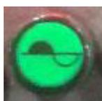
Esta lámpara indica la vibración en el rodillo delantero.
