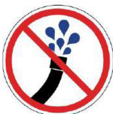
Está prohibido enjuagar el elevador con manguera de agua
