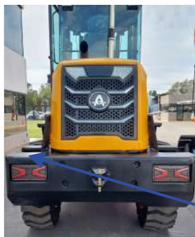
Ubicación de la batería
