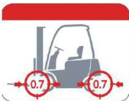
Etiqueta de presión de aire del neumático de carga
